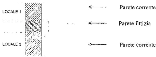
25. **ponte termico** è la discontinuità di isolamento termico che si può verificare in corrispondenza agli innesti di elementi strutturali (solai e pareti verticali o pareti verticali tra loro).
